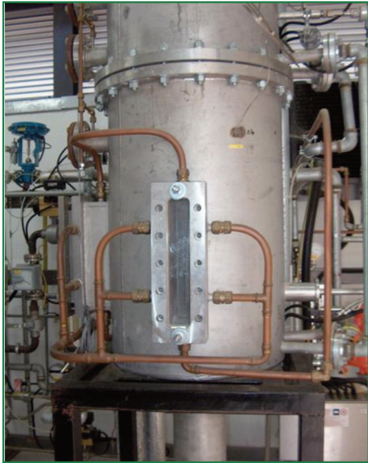
Particolare di una delle quattro finestre ottiche in quarzo per diagnostiche ottiche o laser
