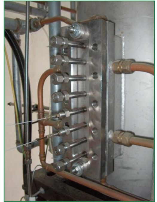
Accesso multi-strumentato con sensori ottici ODC® (brevetto ENEA) per misure di stabilità di combustione e velocità
