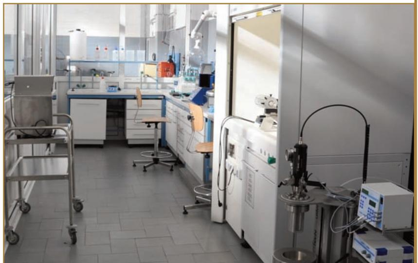
Oltre alle determinazioni di carattere analitico, nel Laboratorio è possibile eseguire attività di sperimentazione chimico-fisica complesse come la distillazione frazionata sotto alto vuoto di liquidi alto-bollenti e la sintesi chimica mediante processi in condizioni estreme, impiegando reattori che consentono operare ad elevate pressioni e temperature (fino a 300 °C e 300 bar).
