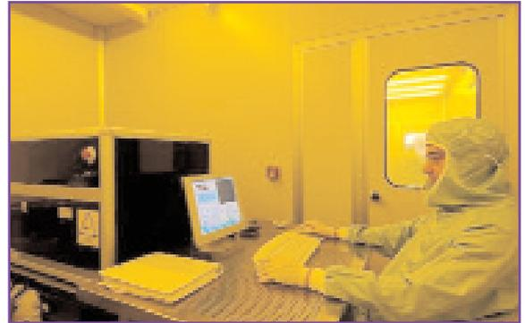
Misura di efficienza quantica di celle solari a giunzione singola o multipla
