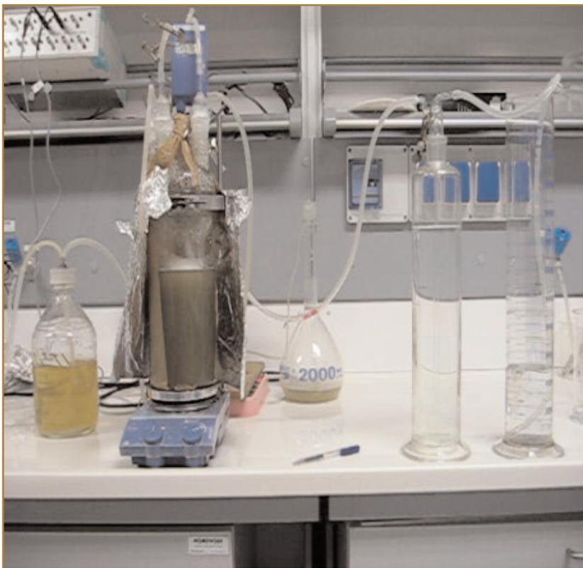
Fermentatore in continuo con elevata produzione di idrogeno
