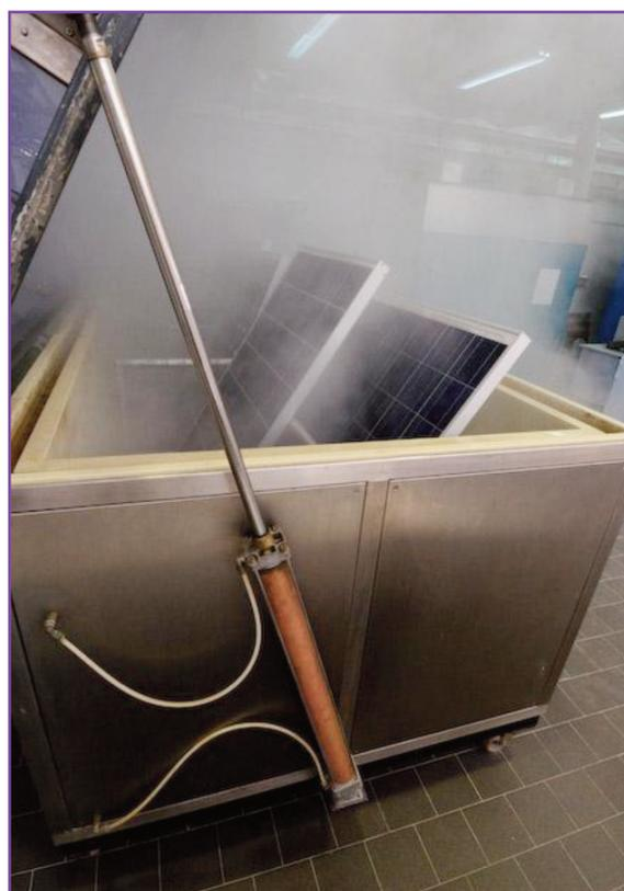
Moduli fotovoltaici nella camera per il test di corrosione salina: il processo di corrosione è innescato spruzzando continuamente o a intermittenza una miscela salina a pH acido controllato
