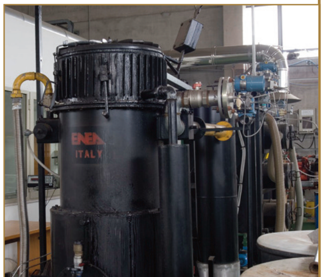
Gassificatore a letto fisso equicorrente (down-draft) da 30 e 80 kW e
