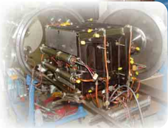
Prove di flusso termico su prototipi di prima parete di ITER rivestiti in berillio. Thermal test on ITER first wall beryllium armoured prototypes.
