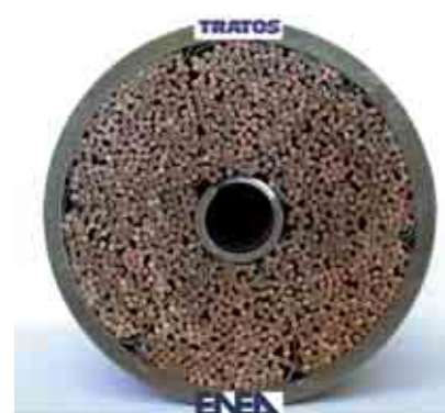
Prototipo di cavo superconduttore per il magnete toroidale di ITER - Prototype of the superconducting cable for ITER toroidal magnet (TRATOS Cavi and ENEA).
