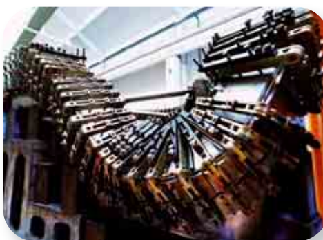
Avvolgimenti superconduttivi per le bobine dei magneti di Wendelstein 7-X - Superconducting coil for Wendelstein 7-X (ASG Superconductors).
