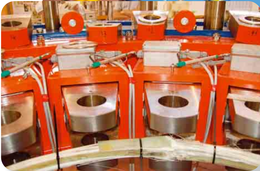
Impianto di prova per gli anelli di serraggio del magnete toroidale. Sotto: particolare dell'impianto con, in evidenza gli anelli, in fibra di vetro. Machine for testing the toroidal field coils pre-compression rings. Below: a detail showing, in the foreground, the glass fiber rings.
