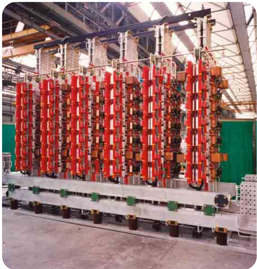
Prototipo a piena potenza del convertitore AC/DC a tiristori ( \pm 45 \text{ kA}/\pm 2.5 \text{ kV} ) per servizio continuativo e con Fault Suppression Capability .
