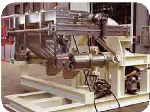
Struttura di supporto per il sistema di riscaldamento ICRH del JET - Support structure for the ICRH heating system at JET (Fantini Sud).
