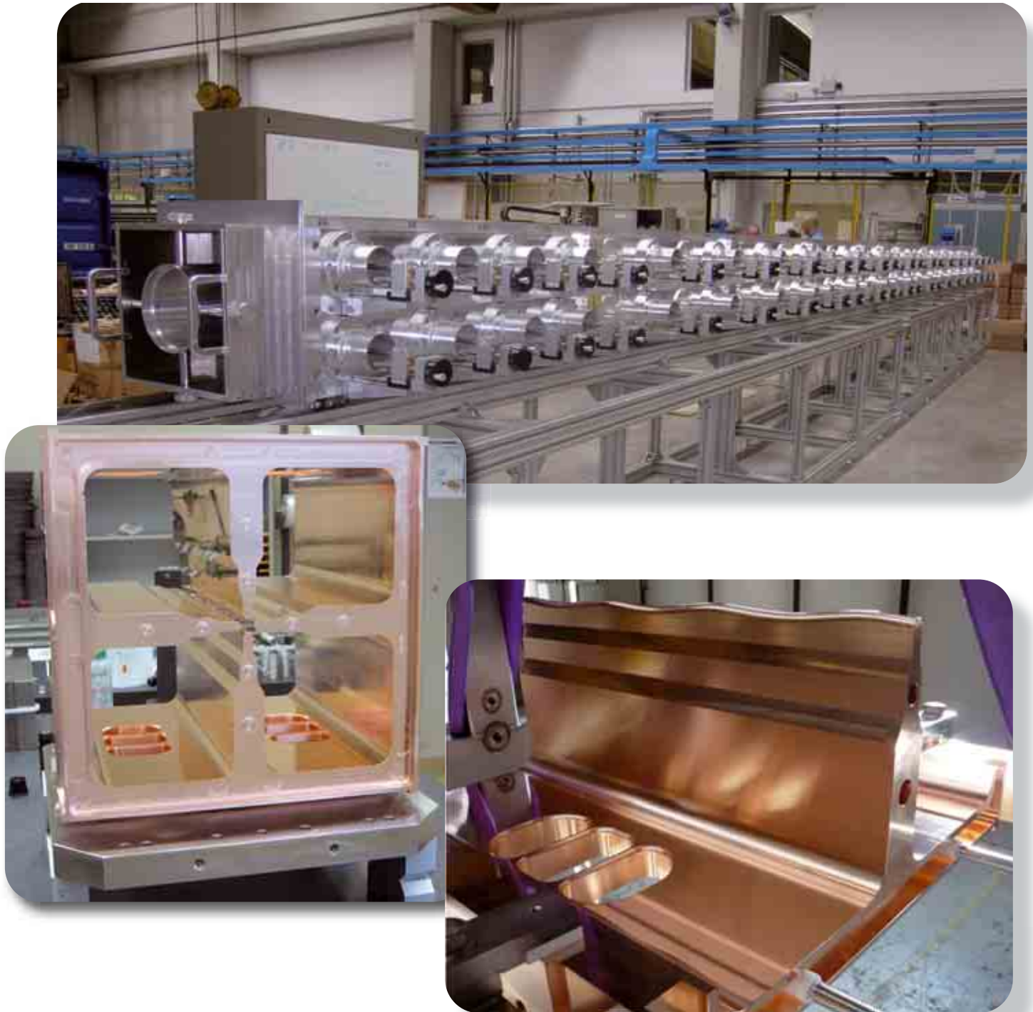
Prototipo in scala naturale dell'acceleratore RFQ a bassa potenza installato presso i Laboratori Nazionali di Legnaro (INFN) e, sotto, il primo prototipo in rame realizzato nelle Sezioni INFN di Padova e Torino.
