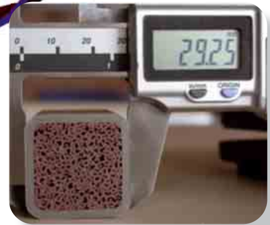
Sezione del cavo del magnete toroidale di JT-60SA.
