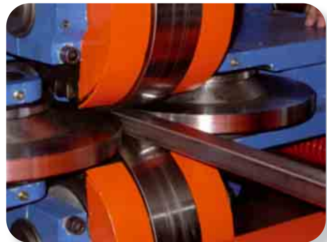
Compattazione del cavo di JT-60SA presso i laboratori di Frascati.
