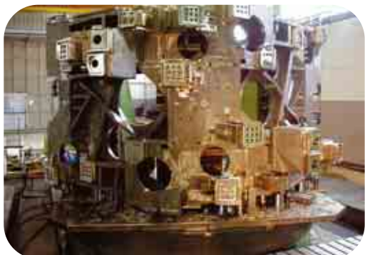
Modulo del supporto centrale delle bobine toroidali di Wendelstein 7-X - A module of the central support structure of the Wendelstein 7-X toroidal field coils (Ravera Costruzioni Meccaniche).
