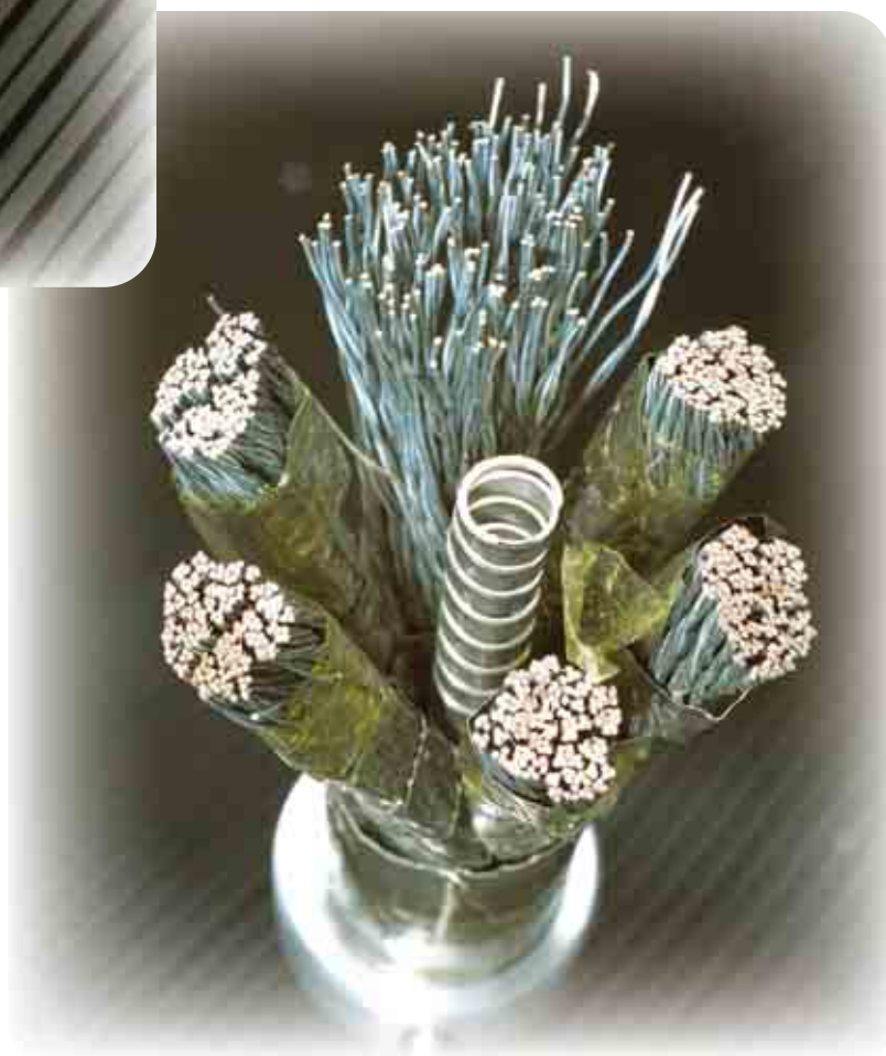
Cavo-in-condotto per i magneti poloidali di ITER (sinistra); particolare del conduttore per il magnete toroidale di ITER (destra).
