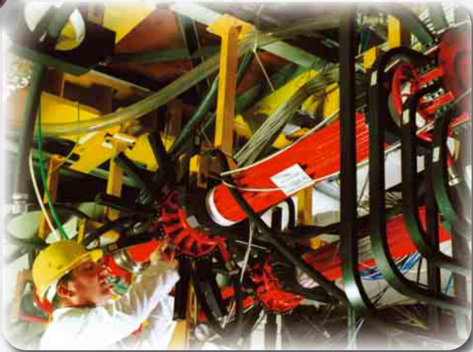
Divisore della potenza LH su 12 guide d'onda.
