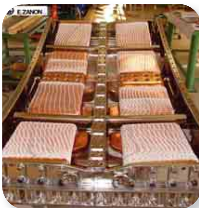
Corpo principale dell'antenna ITER-Like del sistema di riscaldamento ICRH del JET - Main body of the ITER-like antenna of the ICRH heating system at JET (Ettore Zanon SpA)
