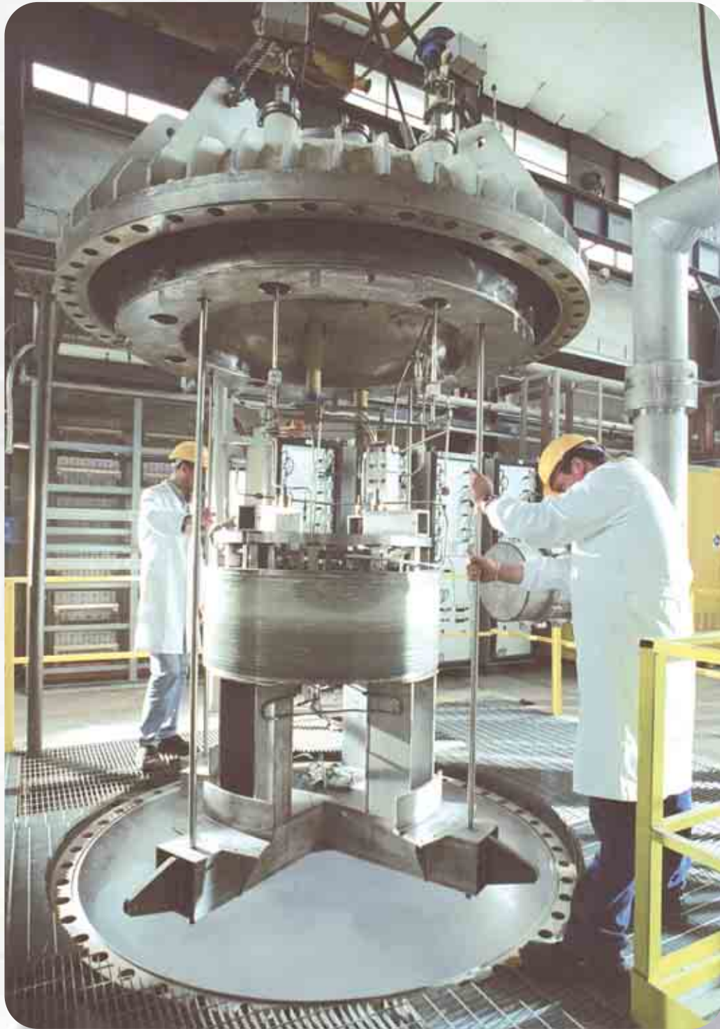
Il magnete di background dell'impianto per la caratterizzazione di cavi-in-condotto. The background magnet of the facility for the cable-in-conduit characterization facility being inserted in the cryostat.
