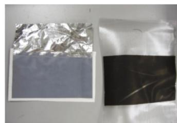
8. Elettrodi pronti per il montaggio in batteria
