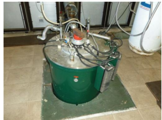
*Criostato equipaggiato con magnete superconduttore da 14 T*
