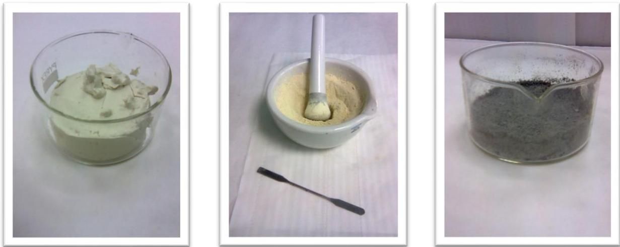
**Figura 46. Fasi di preparazione del  $\text{LiFePO}_4$ . A sinistra:  $\text{FePO}_4$  ottenuto dopo filtrazione. Al centro: Il prodotto macinato prima dell'aggiunta del reattivo litante. A destra:  $\text{LiFePO}_4$  ottenuto per trattamento a 550°C.**
