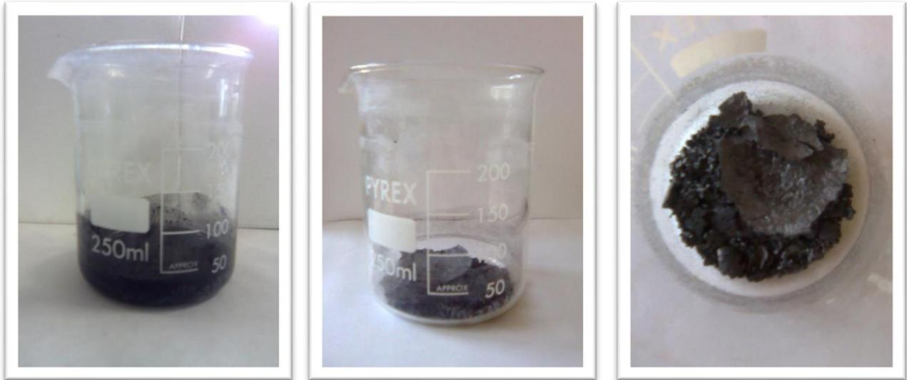
**Figura 48.** A sinistra: soluzione di TYZOR<sup>®</sup>-LA in cui è stato disperso il carbone Super P dopo sonicazione. Al centro: La stessa soluzione dopo evaporazione del solvente. A destra. Materiale ottenuto dopo calcinazione del residuo dell'evaporazione condotto a 400°C per 2 ore.
