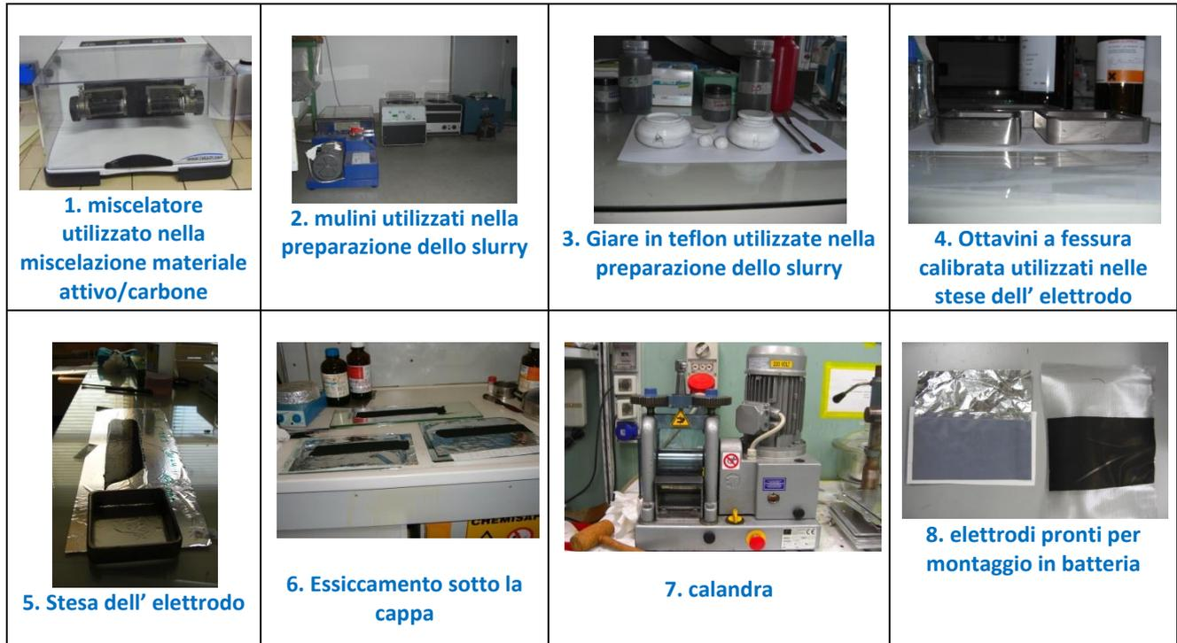
**Figura 21. Immagini relative alla preparazione degli elettrodi**
