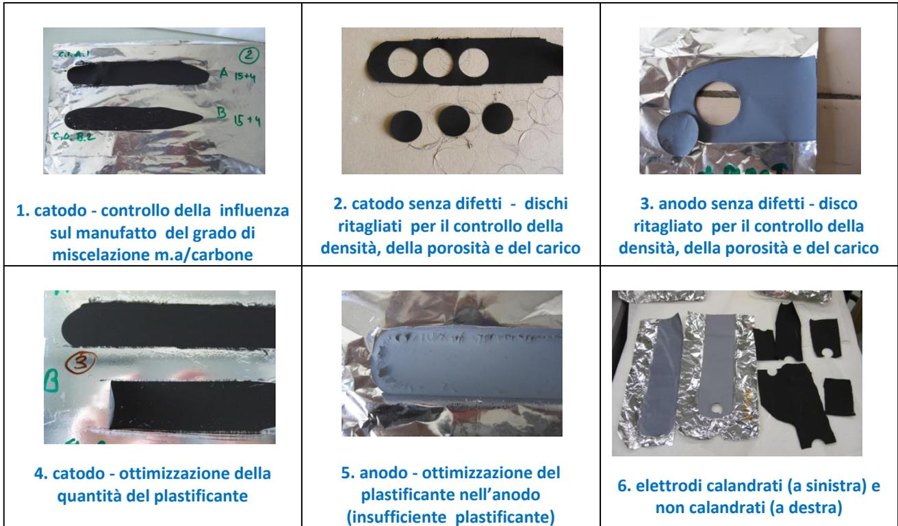
Figura 22. Ottimizzazione degli elettrodi preparati nei laboratori ENEA.
