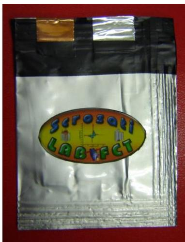
Figura 4. Prototipo di cella litio-ione (pouch cell) in scala di laboratorio.
