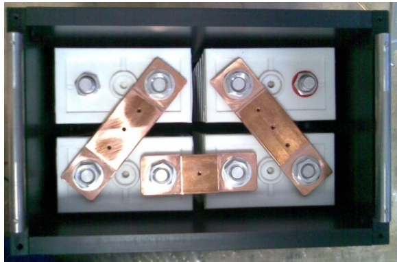
Figura 13. Vista interna dei nuovi moduli batterie: 30 Ah e 60 Ah (sinistra), 100 Ah (destra)
