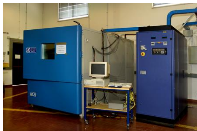
Figura 3. Camera climatica (sinistra) e ciclatore (destra)
