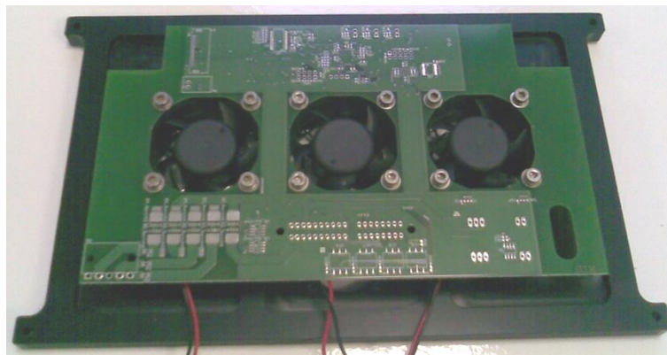
Figura 14. Nuova posizione della scheda elettronica BMS
