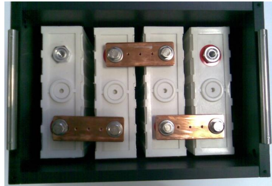
Figura 13. Vista interna dei nuovi moduli batterie: 30 Ah e 60 Ah (sinistra), 100 Ah (destra)
