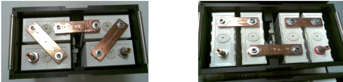
Figura 2. Vista interna dei moduli batterie: 30Ah e 60Ah (sinistra), 100Ah (destra)
