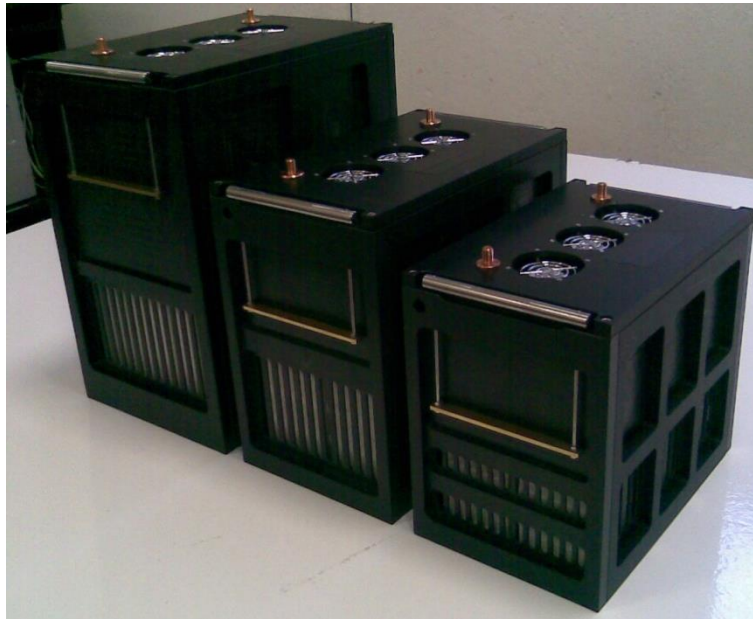
Figura 15. Nuovi moduli batterie realizzati: 30 Ah (destra), 60 Ah (centro), 100 Ah (sinistra)
