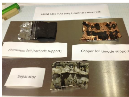
Figura 5. Parte dei componenti della batteria Sony 18650 separati.
