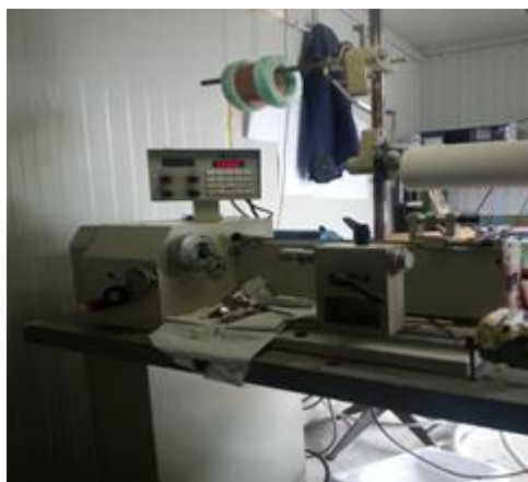
Figura 18. Nastratrice usata per la produzione di avvolgimenti di YBCO.
