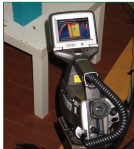
Analisi termografica di una cella al litio durante le prove di "second life"
