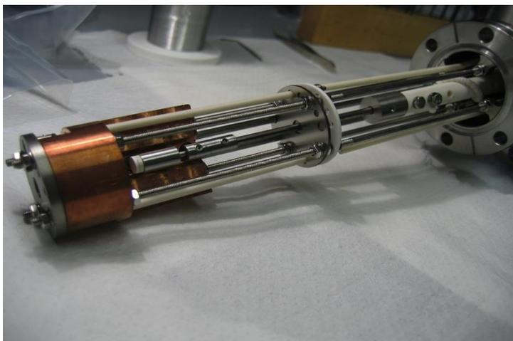
Figura 5. Evaporatore a bombardamento elettronico
