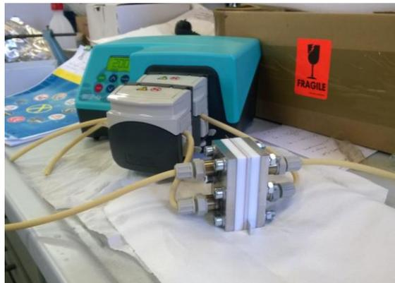
**Figura 4. Cella assemblata e collegata alla pompa peristaltica.**
