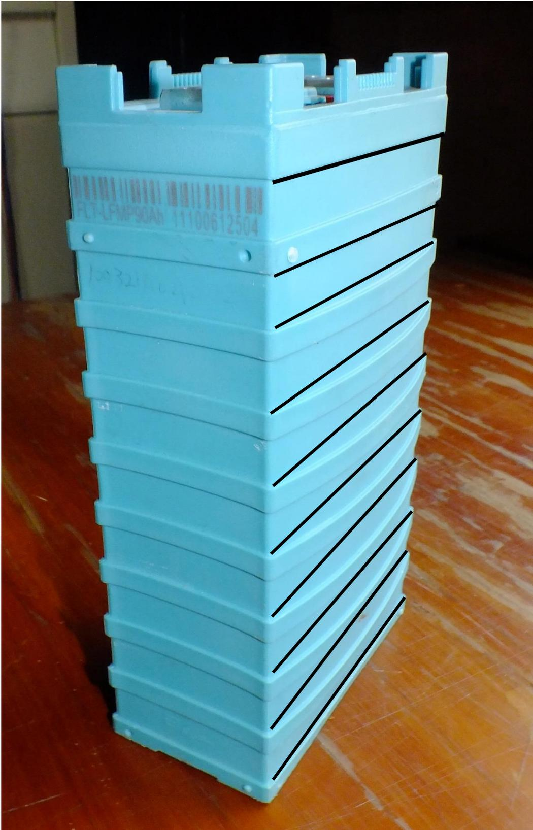
Figura 14. Deformazione del contenitore della cella in prova
