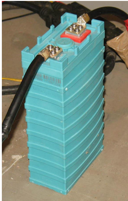
Figura 19. Rigonfiamento della cella dopo circa 70 cicli
