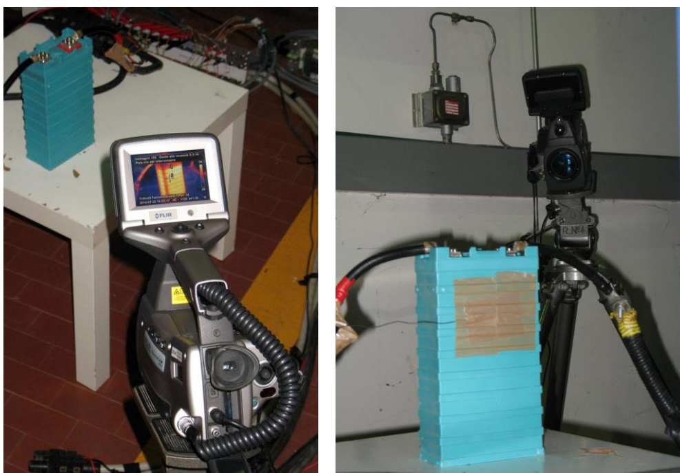
Figura 1. Termografia su cella in esercizio
