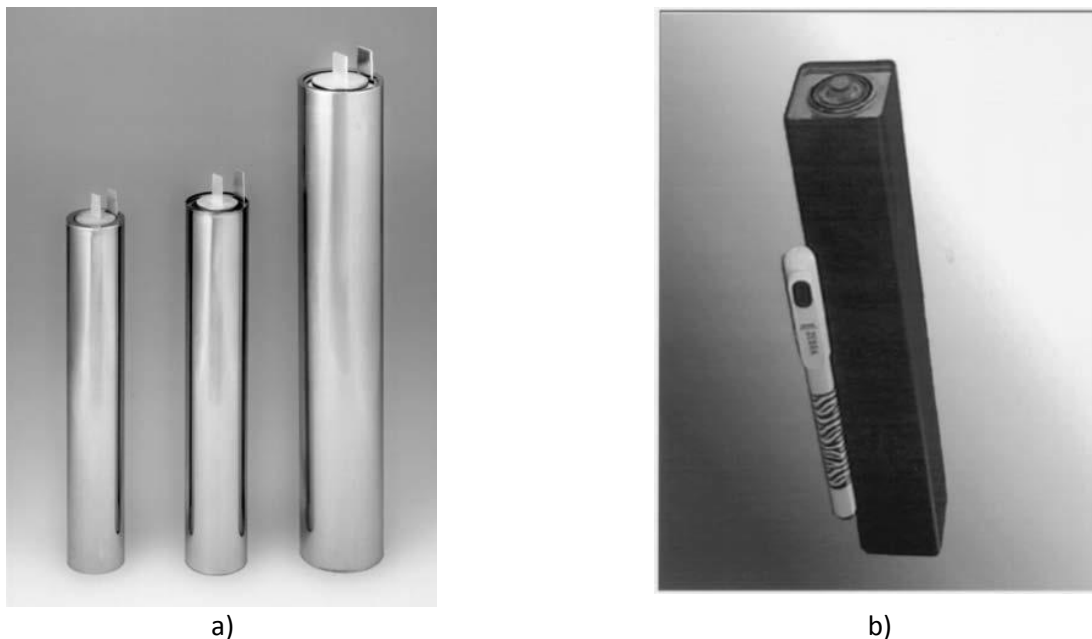
Figura 3. Moderne celle Sodio/beta: a) tre celle Sodio/Zolfo NGK (da sinistra a destra: T4.1, T4.2, T5.1) e b) cella Sodio/Nichel MES DEA, ML3. Per riferimento: la cella NGK più grande ha diametro 91 mm e altezza 515 mm; la cella MES ML3 ha sezione di 36 mm 2 e altezza di 232 mm. (Fonte: Photographs courtesy of Tokyo Electric Power Company and NGK Insulators, Ltd. (a) and MES-DEA SA (b)).
