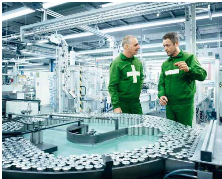
Figura 5. Linea di selezionamento batterie esauste.
