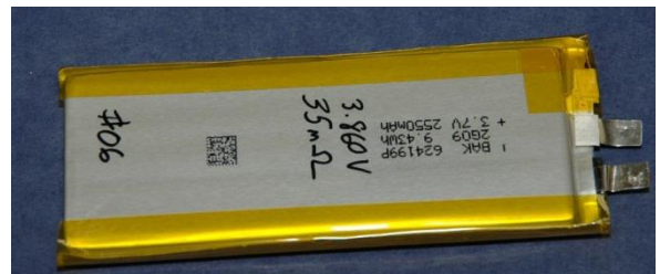
Figura 8. Cella soft pouch (Fonte: [18]). Dall'alto verso il basso: separatore, separatore, anodo su foglio di rame, catodo su foglio di alluminio.
