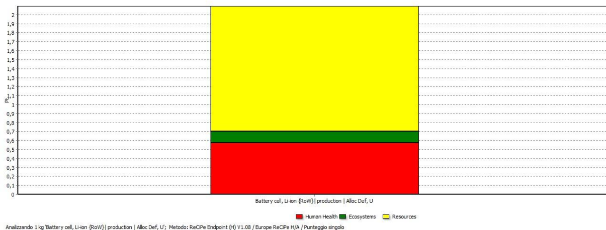
Figura 24: valutazione degli impatti della produzione di batterie, punteggio singolo, metodo ReCiPe.
