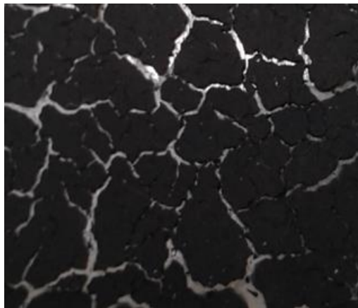
Figura 2. Elettrodo ottenuto per disidratazione lenta di una miscela di materiale attivo carbone, PVAc ed acqua.
