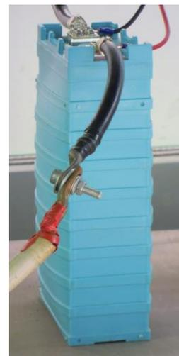
**Figura 26. a) Andamento della temperatura massima, di quella ambiente e della capacità; b) Rigonfiamento della cella 5 dopo i 121 cicli**
