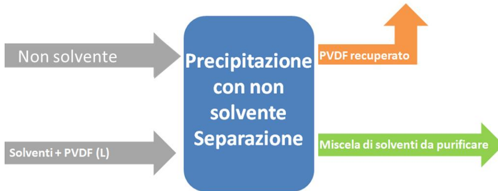
Figura 7. Processo di recupero del legante PVDF e del solvente
