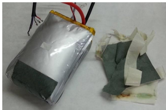
Figura 17. Rimozione dei nastri adesivi
