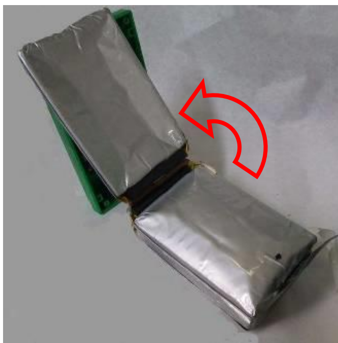
Figura 18. Rotazione della singola cella dal pacco batterie
