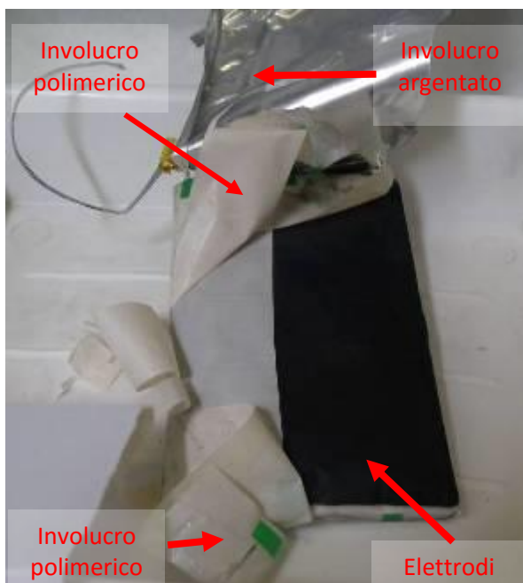
Figura 22. Apertura dell'involucro polimerico ed estrazione degli elettrodi
