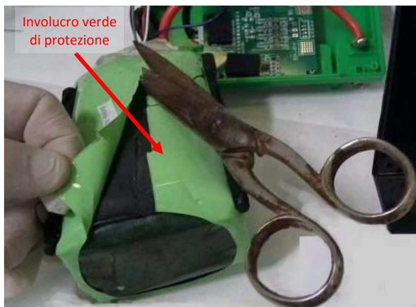
Figura 13. Taglio e rimozione dell'involucro di protezione verde
