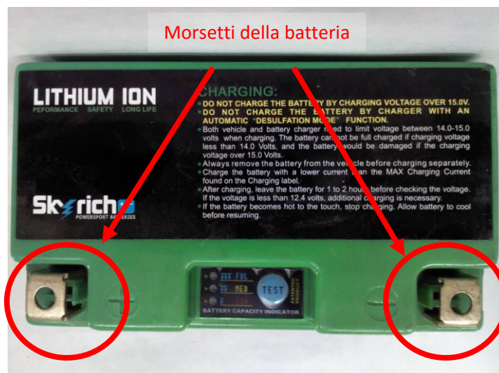
Figura 5. Scarica della batteria: morsetti esterni
