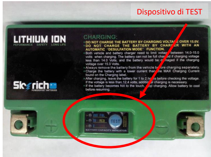
Figura 3. Test di verifica dello stato di carica: display che indica lo stato di carica della stessa
