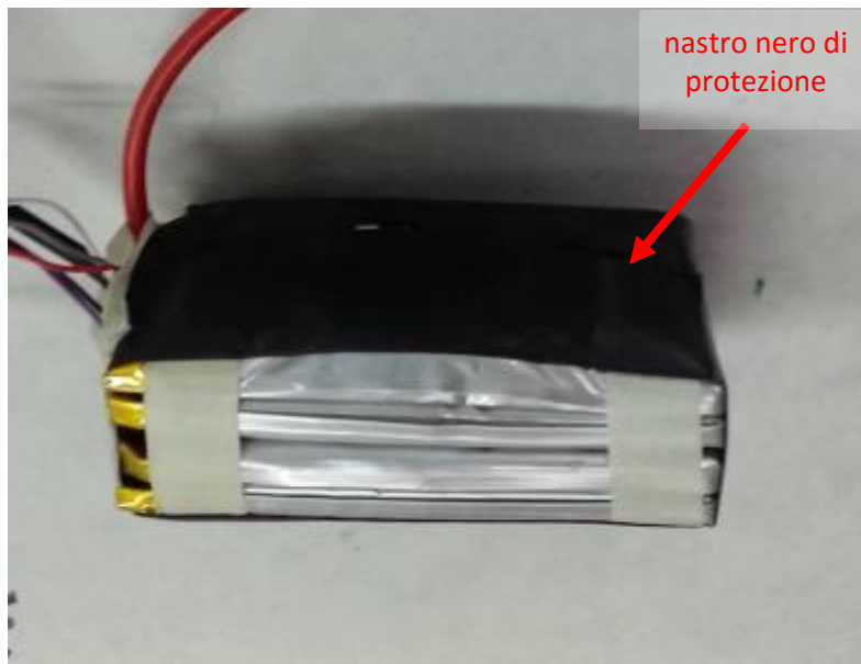
Figura 15. Rimozione dell'involucro nero di protezione
