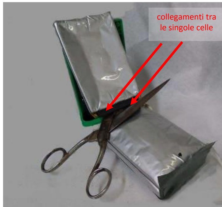
Figura 19. Taglio dei collegamenti tra le singole celle del pacco batterie
