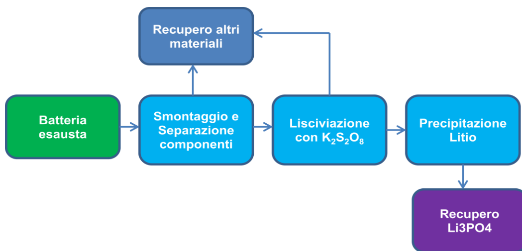
Figura 10. Schema del processo di recupero del litio preceduto dal metodo 2 di pretrattamento della batteria Li-ione
