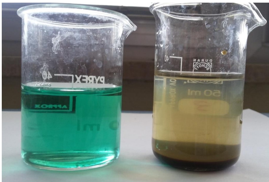
Figura 7. Soluzione in TISAB prima e dopo la precipitazione di idrossido ferrico in fase di sedimentazione
