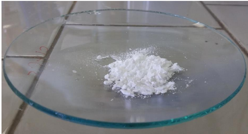
Figura 11. Recupero del precipitato di fosfato di litio dopo filtrazione ed essiccamento
