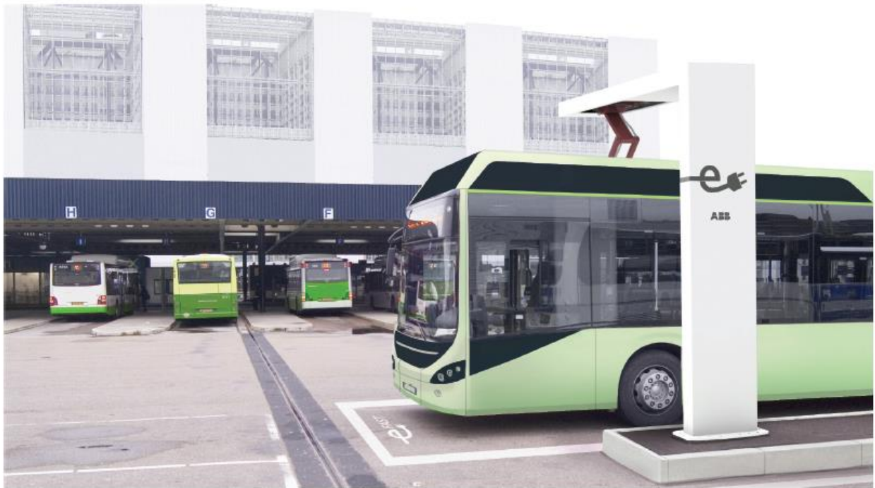
Figura 5. Stazione di ricarica veloce automatica per bus con "Opportunity charging".
