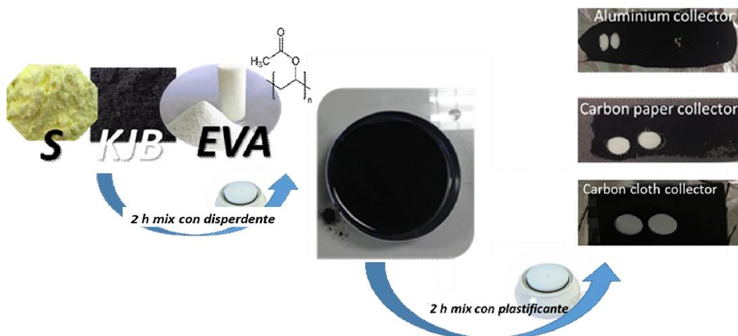
Figura 9: preparazione di elettrodi a base di Carbone e legante polimerico EVA E06 dispersibile in  $\text{H}_2\text{O}$ , utilizzando tre diversi supporti porta corrente: alluminio, carbon paper, carbon cloth.
