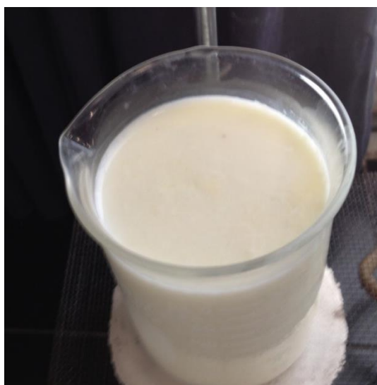
Figura 1. A sinistra: immagine del fosfato di ferro (III) preparato per ossidazione del solfato di ferro in presenza di fosfato di ammonio. A destra: la centrifuga Rotanta 460 utilizzata per centrifugare la soluzione ed effettuare i lavaggi.
