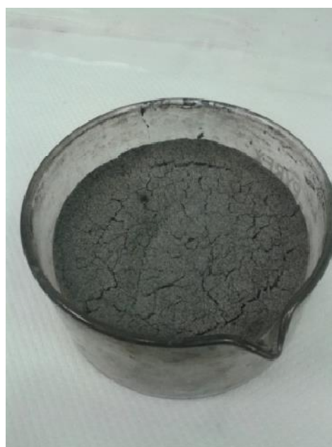
Figura 5. A sinistra: immagine della miscela tra fosfato di ferro e acetato di litio prima della reazione di sintesi. A destra: immagine del LiFePO 4 ottenuto dopo sinterizzazione dei precursori a 550°C.
