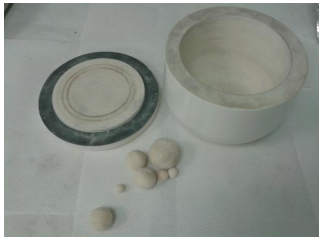
Figura 3. A sinistra: immagine del fosfato di ferro anidro ottenuto dopo trattamento a 300°C . A destra: mulino a palle utilizzato per mescolare il litio acetato ed il ferro fosfato anidri.
