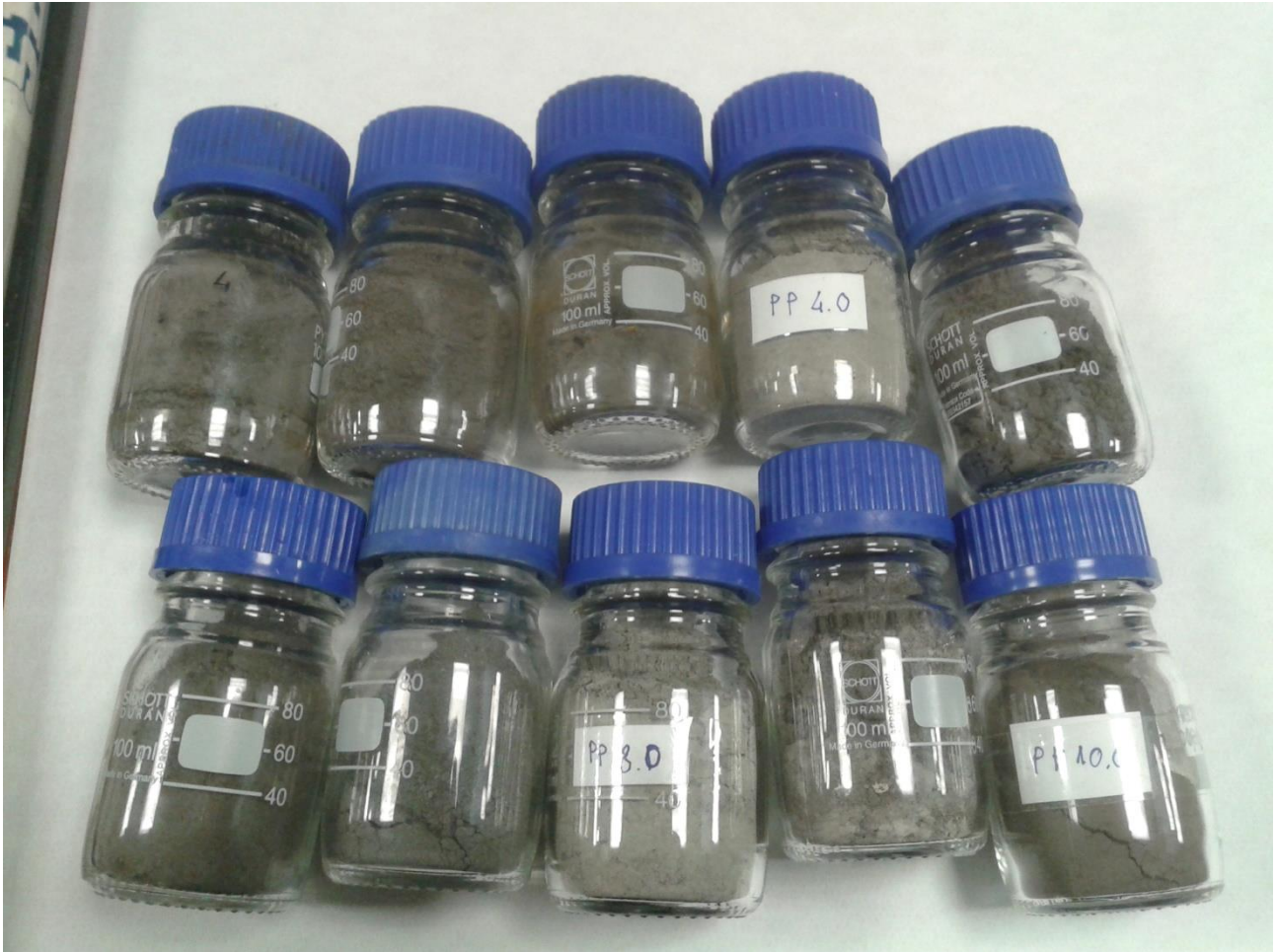
Figura 48. I dieci campioni di \text{LiFePO}_4 da 50 grammi ciascuno che sono poi stati riuniti per formare il campione PP 11.0 da 500 grammi.
