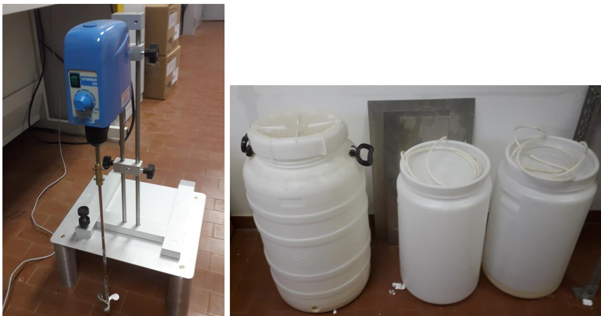
Figura 5. A sinistra: agitatore Stirrer ES della VELP Scientifica per preparare le soluzioni dei reagenti. A destra: serbatoi in plastica per il contenimento delle soluzioni.
