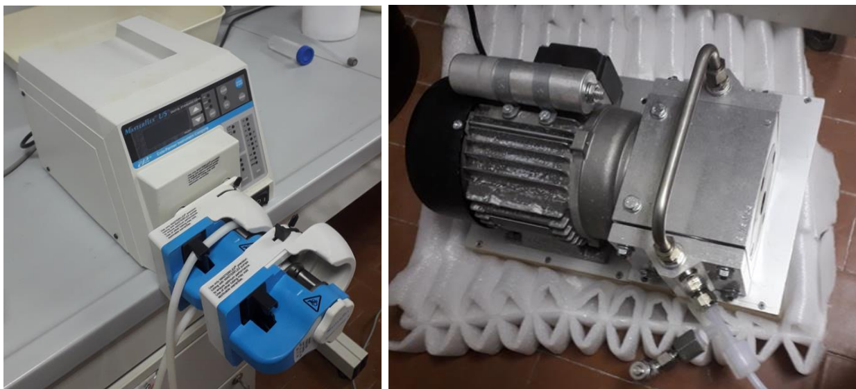
Figura 4. A sinistra: Pompa peristaltica (Masterflex 7523-60) equipaggiata di due teste pompanti L/S Easy-Load. A destra: pompa peristaltica da vuoto HYCO modello ML86.23
