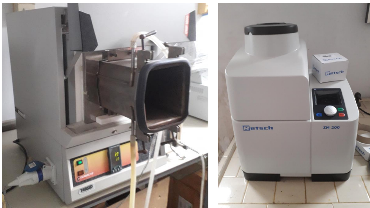
Figura 8. A sinistra: Forno Carbolite, in grado di raggiungere i 1100 C in atmosfera controllata. A destra: mulino della Retsch con rotore a 12 denti ed un setaccio in Conidur con fori da 0.5 mm.
