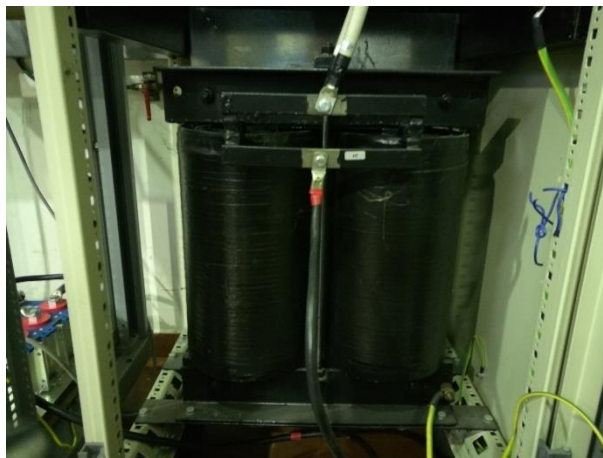
Figura 8. Una delle due induttanze da 4 mH utilizzate per la sperimentazione.
