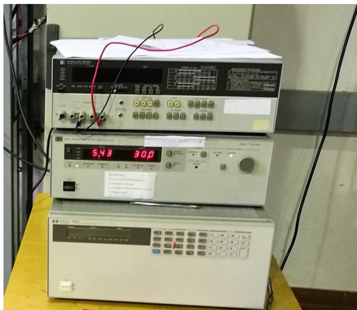
Figura 9 Ponte di misura elettronico HP 4262A LCR Meter (in alto), alimentatore per la ricarica dei supercondensatori (al centro) e carico elettronico per la scarica degli stessi (in basso).
