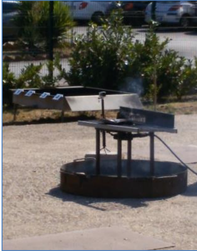
Figura 15. Estinzione a CO2. Ripresa di combustione di una parte della cella
