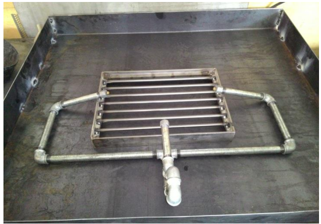
Figura 4. Braciere a tre ugelli
