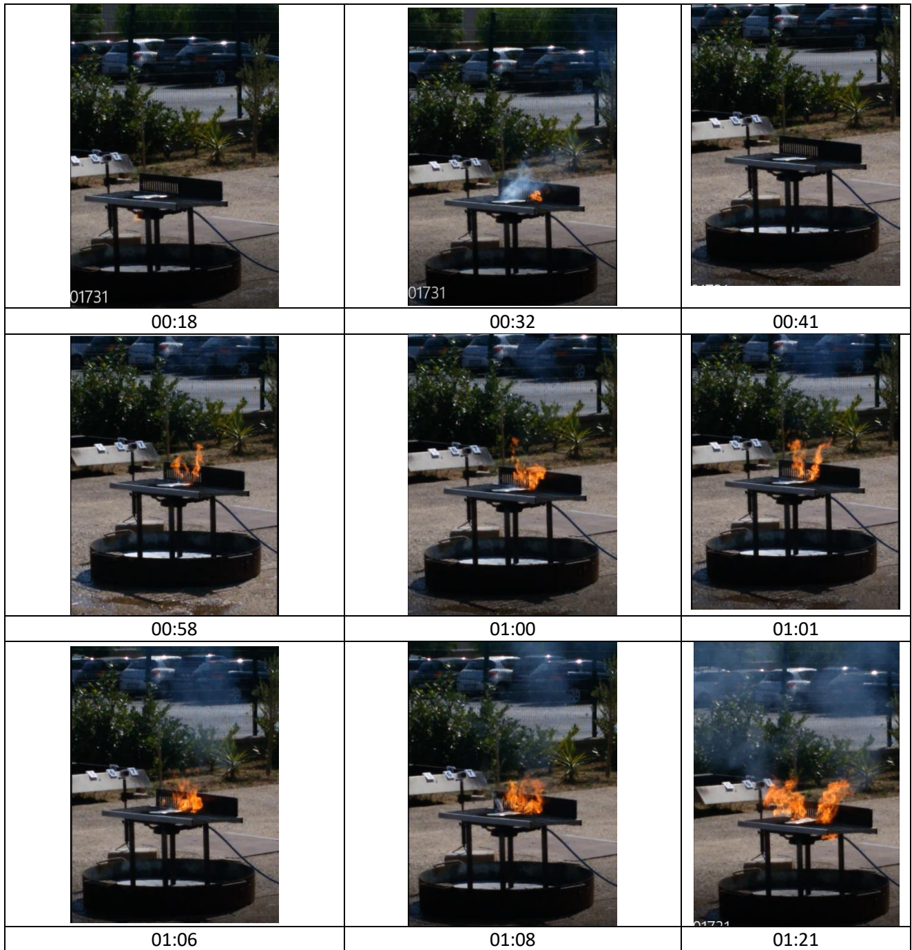
Figura 20. Prova estinzione con polvere: prima dell'estinzione
