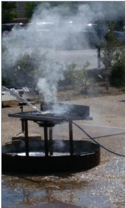
Figura 17. Estinzione ad acqua liquida
