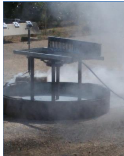
Figura 18. Estinzione con polvere
