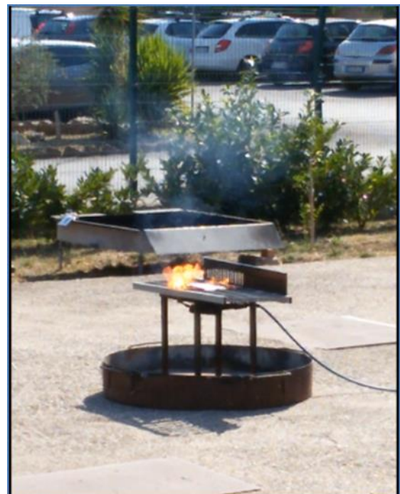
Figura 9. Innesco dei vapori con formazione di fiamma
