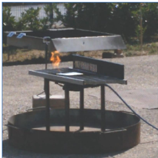
Figura 8. Emissioni di gas e accensione della fiamma
