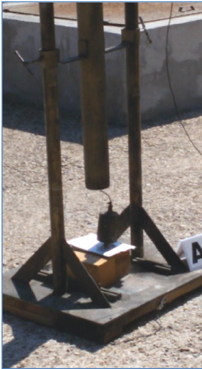
Figura 22. Prova di perforazione
