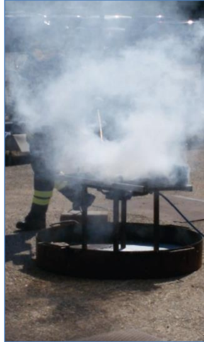
Figura 16. Estinzione ad acqua nebulizzata
