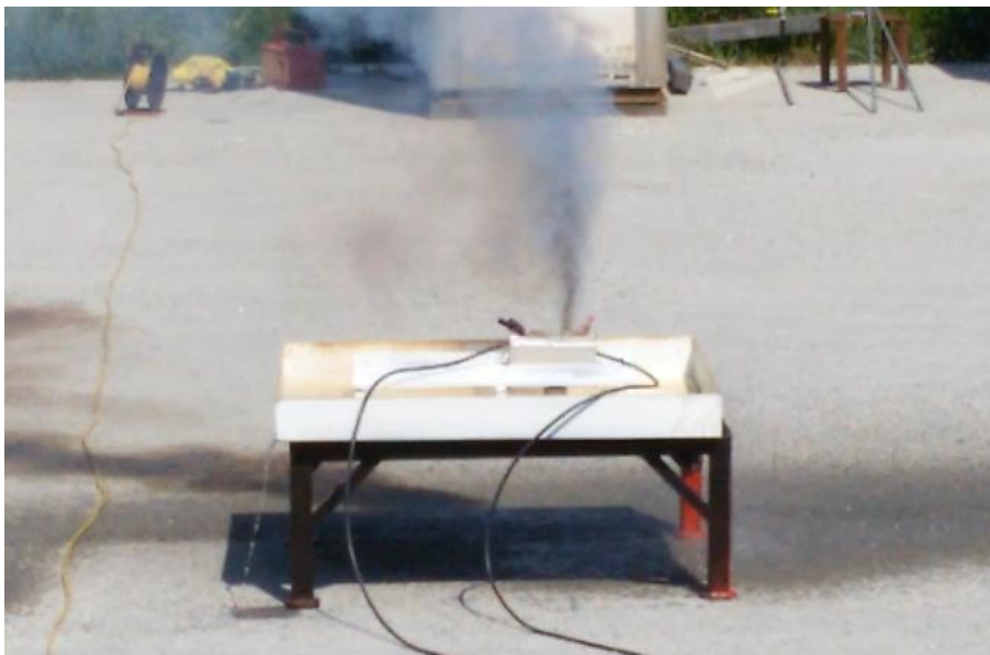
Figura 24 Caso di venting dovuto a prova di overvoltage.
