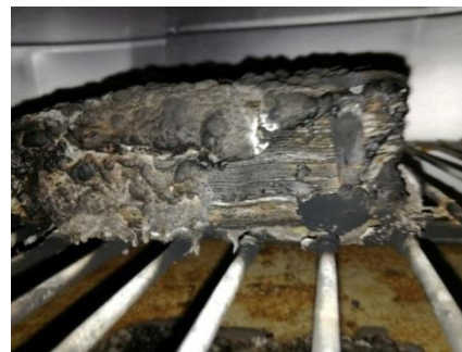
Figura 21. Cella Tundersky TS LFP 60 Ah . Prova di esposizione a fiamma, fino a combustione completa
