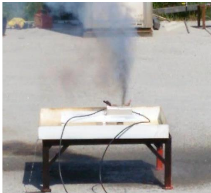
Figura 3 Aerosol emessi dalla cella a seguito di overcharge.
