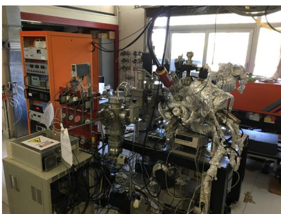
Fig. 4. Apparato sperimentale e schema del setup di misura XPS
