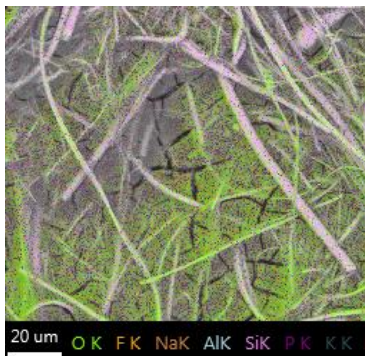
Figura 34. Mappatura EDS di un particolare del campione CP27_AC.
