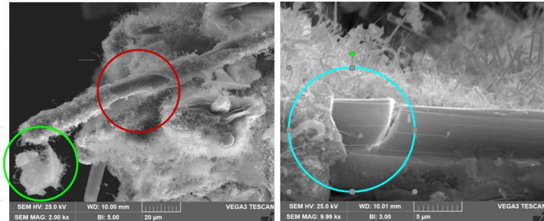
Figura 25. Dettagli della copertura in silicio del campione CP49. Da sinistra 2000x e 10000x
