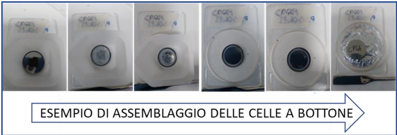
Figura 4. Foto delle varie fasi di assemblaggio delle celle sperimentali.
