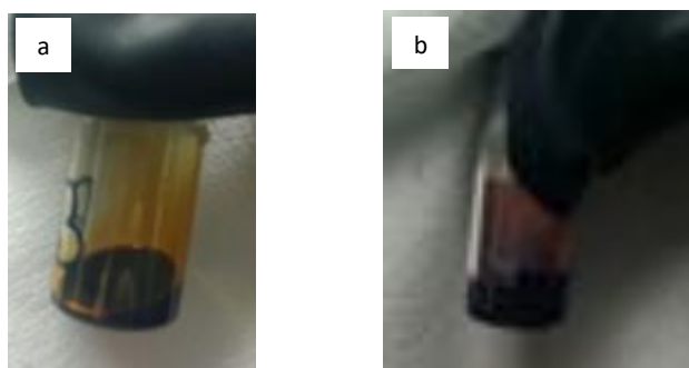
Figura 17. a) a Soluzione di polisolfuri in DOL:DME (1:1) b) Elettrolita composto da DOL:DMSO (1:1).
