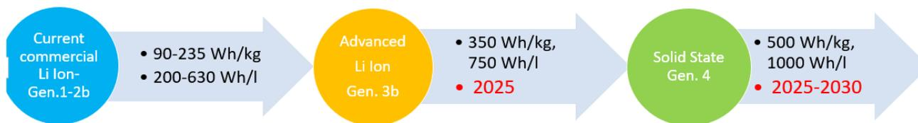
Figura 2 Obiettivi prestazionali e di orizzonte temporale delle diverse generazioni di celle. Fonte da <http://ec.europa.eu/research/index.cfm?pg=events&eventcode=230DABFD-90AB-8F7D-083EF5BD909DD025>
