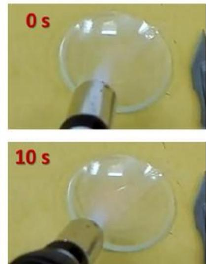
**Figura 7. Test di infiammabilità dei diversi sistemi di elettroliti in esame.**
