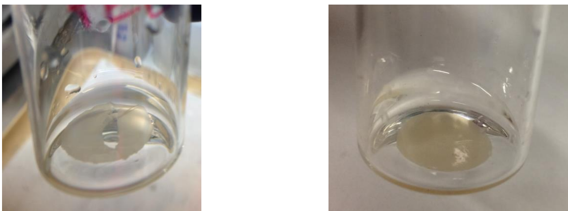
Figura 4. Immagine della membrana (sinistra) PWC immersa per 120 ore in DMSO, si osserva un progressivo degrado della membrana fino a rottura. Immersione della membrana (destra) PWC-NS per 30 giorni in DMSO, la membrana appare ancora intatta.
