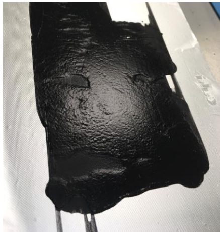
Figura 11: stesa elettroica appena realizzata in cui si evidenzia le presenza di discontinuità nello spessore.
