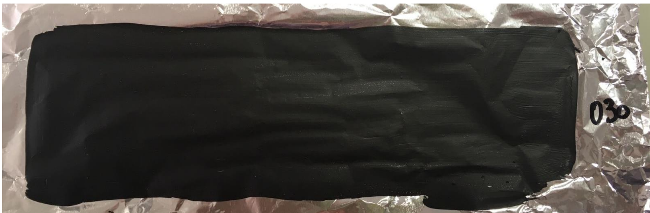
Figura 16: stesa effettuata con pennello della miscela Crilat 7829 e carbone SuperP per realizzare il primo di due strati.
