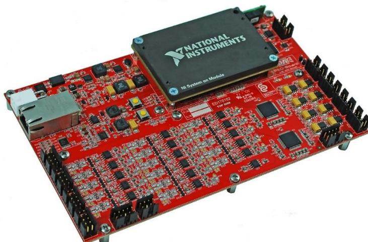
Figura 2. Scheda di controllo PED-Board Mini.
