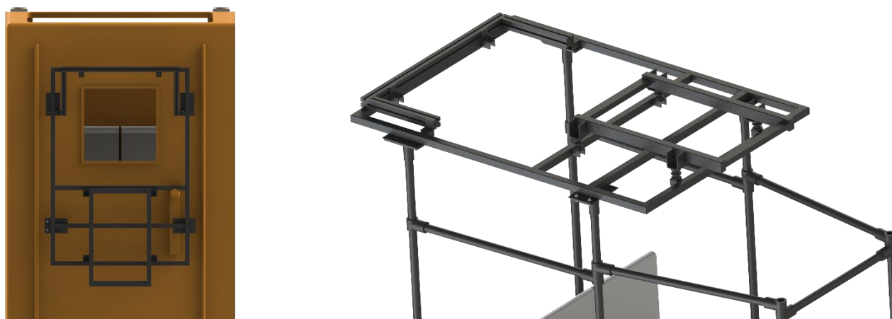
Figura 2 Rendering del telaio di supporto al pantografo. A sinistra: montaggio sul tetto, vista superiore. A destra: dettaglio in vista assometrica.
