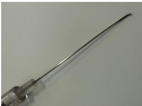
Figura 6 Ago della siringa da gas usata per il campionamento.
