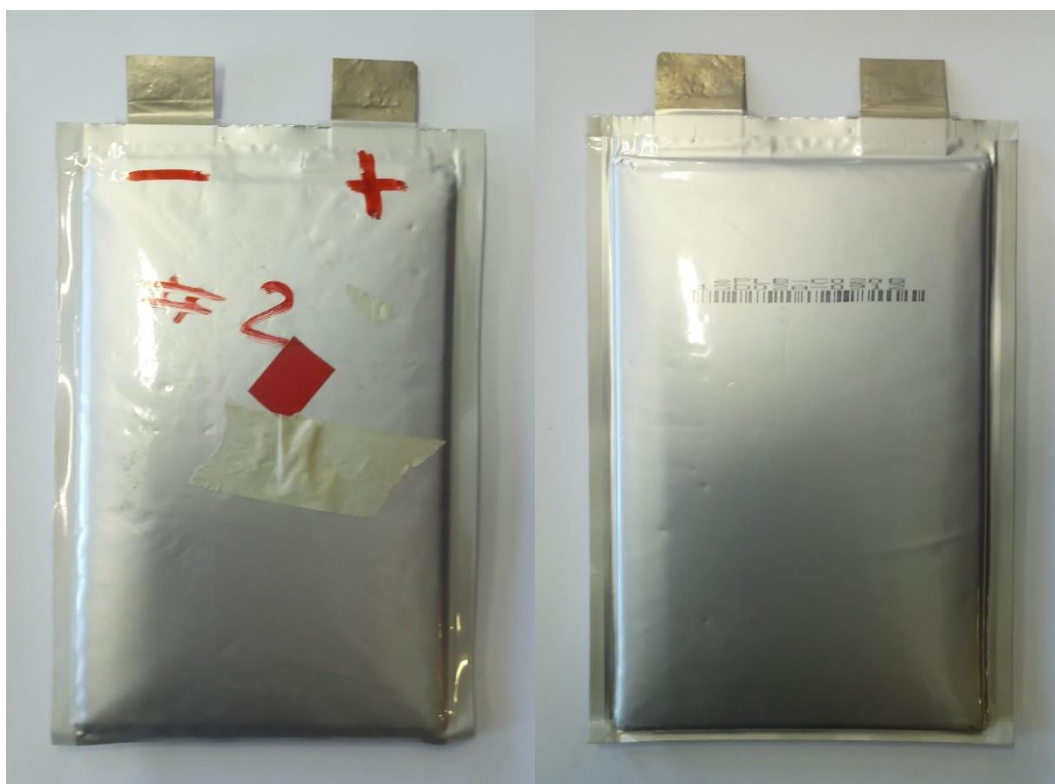
Figura 2 Cella EiG-C020 fine vita #2, visibilmente rigonfia.
