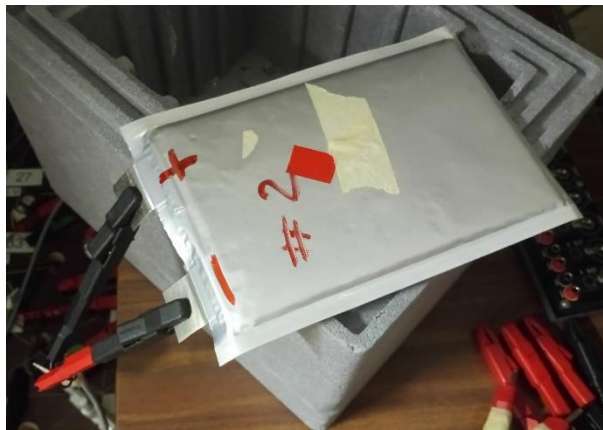
Figura 3 Dispositivo di scarica delle celle EiG-C020.
