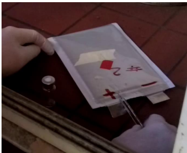
Figura 5 Campionamento di gas e vapori sviluppati nella cella EiG-C020 rigonfia.
