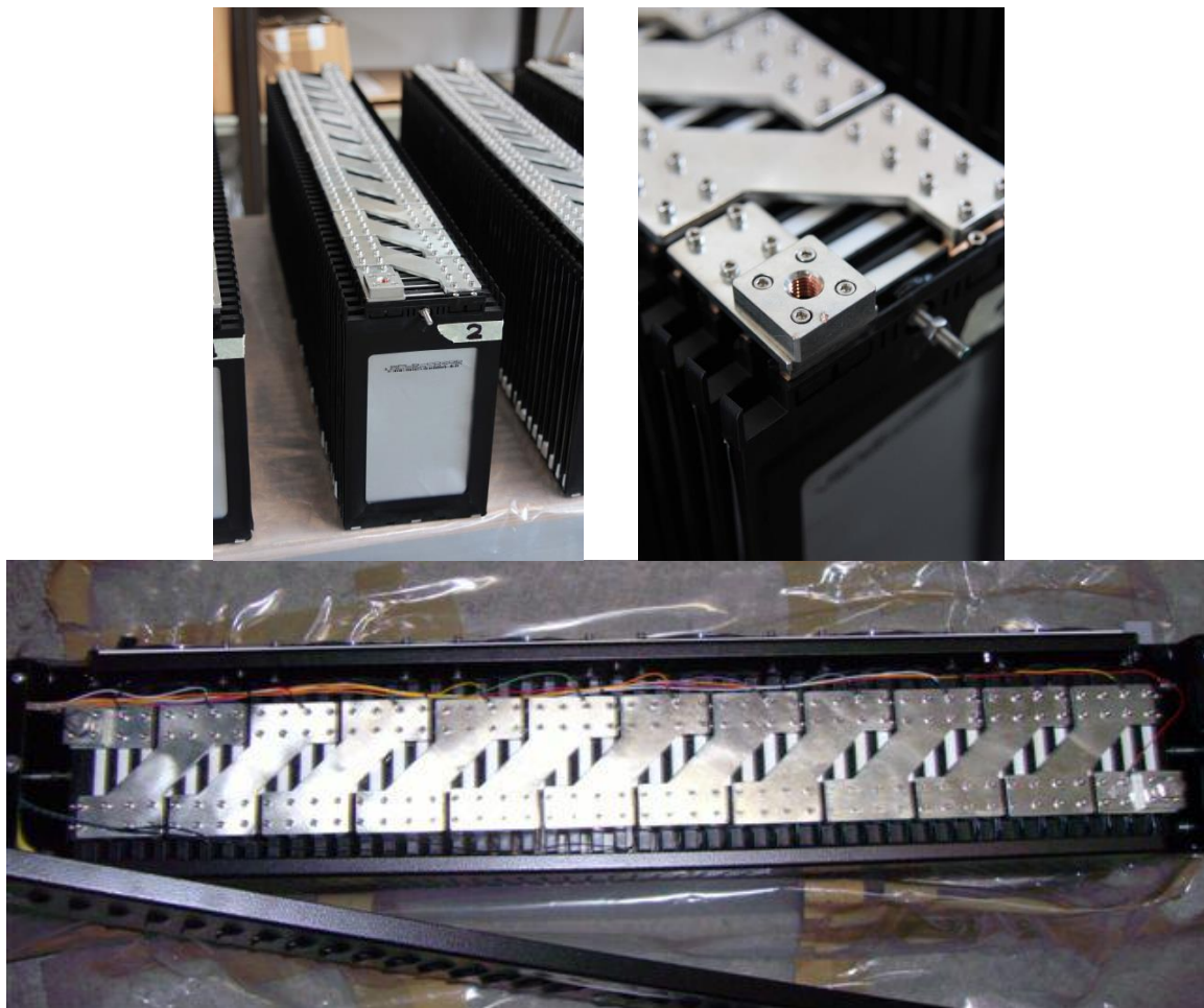
Figura 23. a) Piastre per la messa in parallelo b) Connessioni di potenza c) veduta dall'alto delle connessioni di potenza e dei conduttori di segnale
