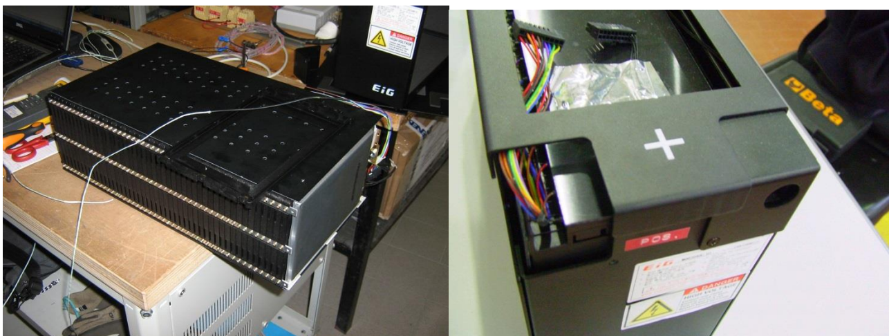
Figura 2. Moduli Microvett a) Celle impilate nel modulo b) Terminale dei collegamenti elettrici
