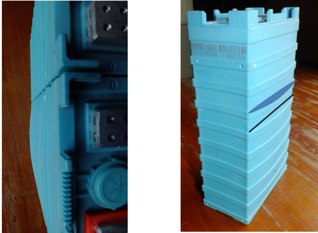
Figura 11. Deformazione di una cella prismatica a) Comparata con una di riferimento b) Evidenziata con riferimenti geometrici
