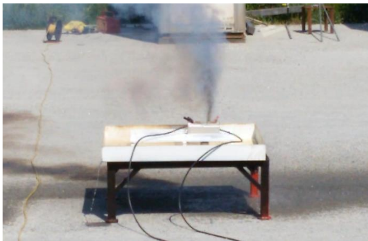
Figura 13. Venting di una cella
