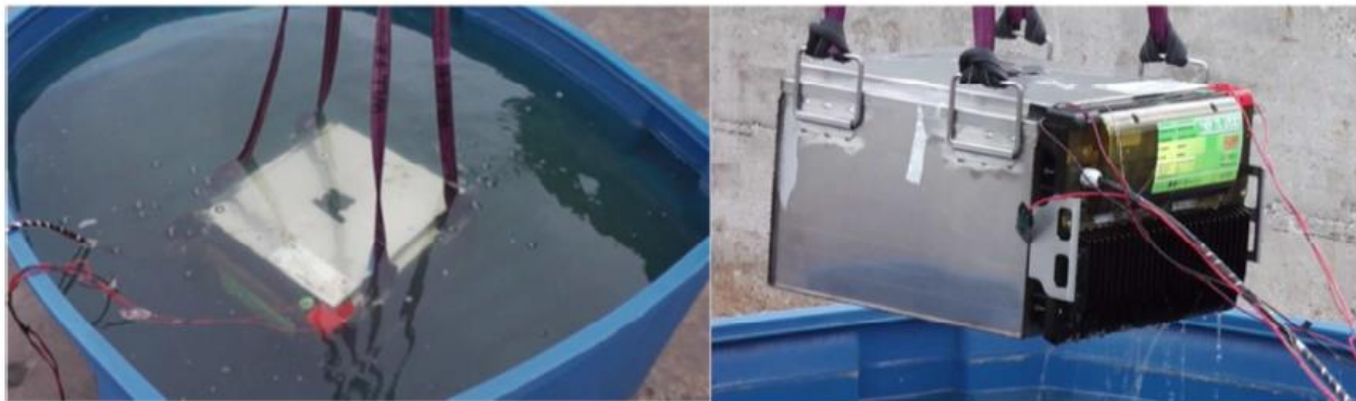
Figura 8. P6. Immersione in acqua salata
