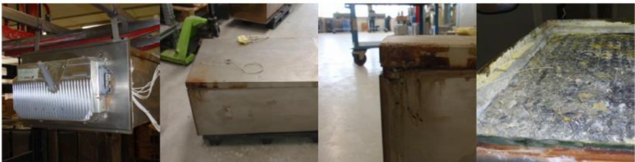
Figura 7. P5. Stato del modulo dopo test di cortocircuito.
