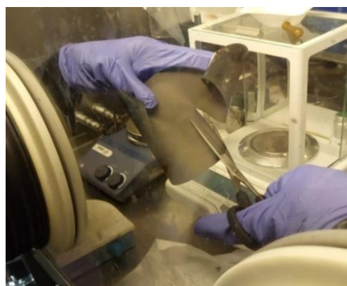
Figura 37. Apertura e campionamento materiali cella
