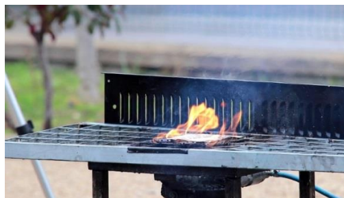
Figura 14 Prova di incendio di una cella EiG-C020 scarica.
