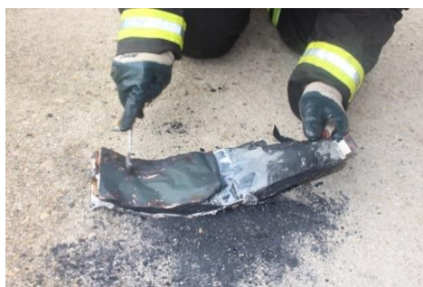
Figura 15 Residui di celle EiG-C020 dopo prove di incendio.
