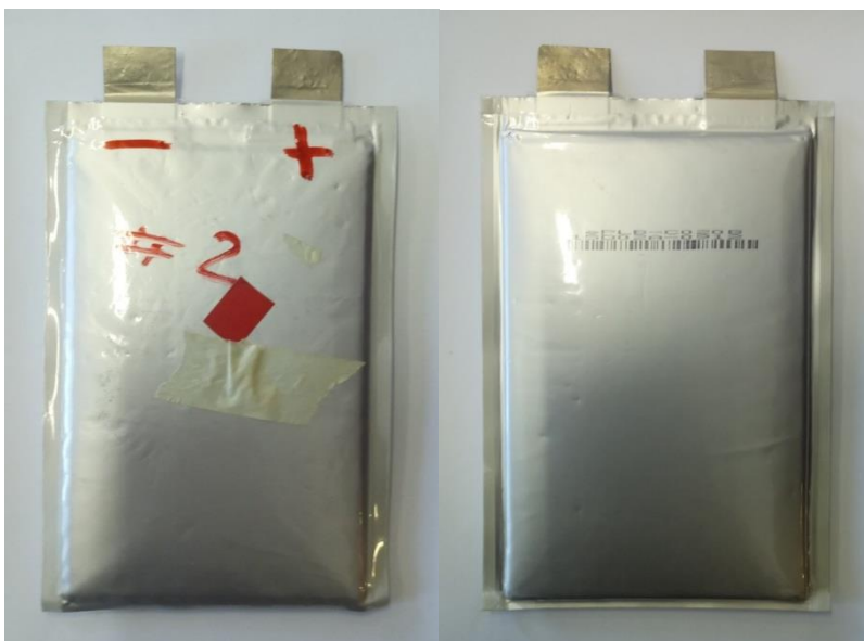
Figura 52 Cella EiG-C020 rigonfia a seguito di prove di invecchiamento.
