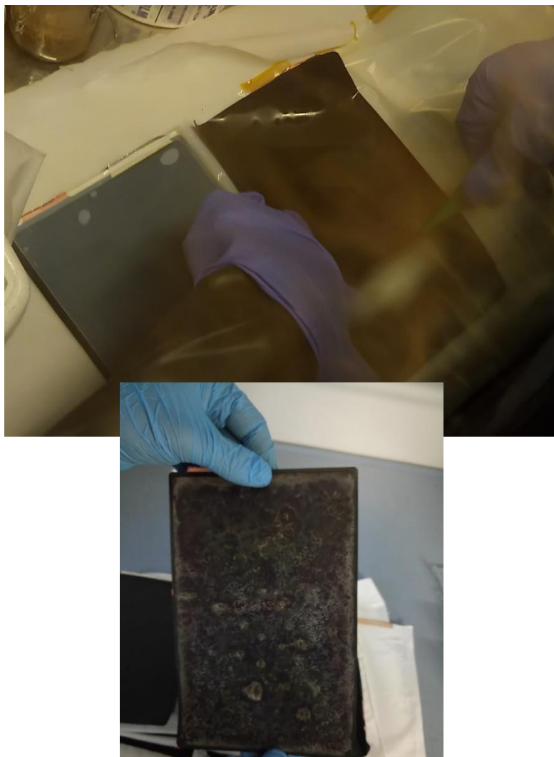
Figura 60 Anodo di una cella EiG-C020 vergine (sinistra) e rigonfia (destra).
