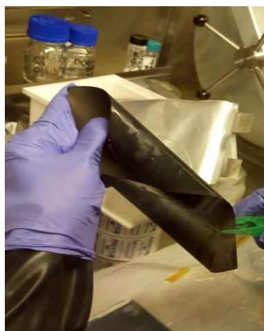
Figura 37. Apertura e campionamento materiali cella
