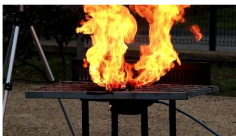
Figura 13 Prova di incendio su una cella EiG-C020 carica.
