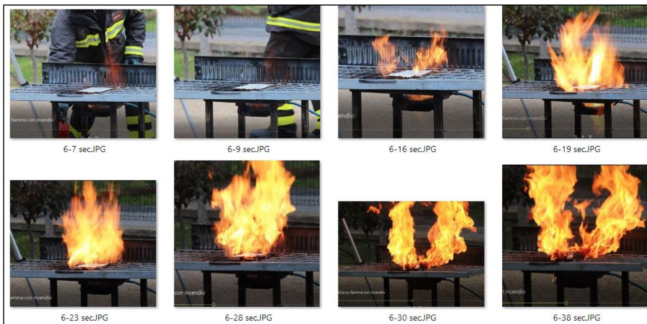
Figura 18. P4 – Cella carica. Telecamera. Accensione bruciere a 7 sec del filmato. Parte 1
