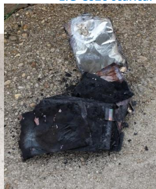
Figura 15 Residui di celle EiG-C020 dopo prove di incendio.
