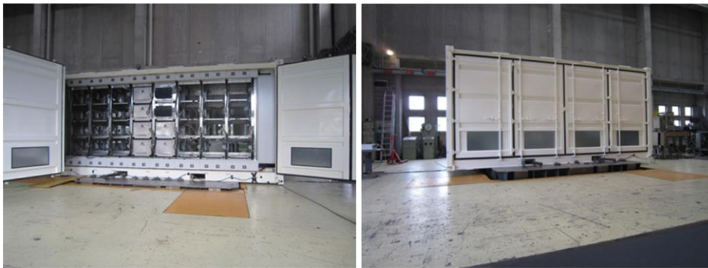
Figura 12. Test sismico e test di trasporto su strada sull'unità di accumulo [Errore. Il segnalibro non è definito.]
