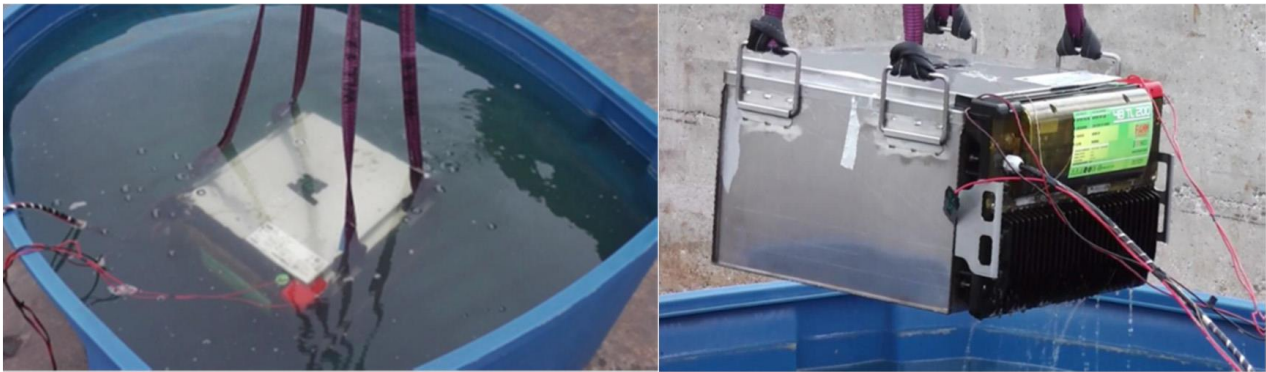
Figura 8. Test di immersione in acqua salata [Errore. Il segnalibro non è definito.]
