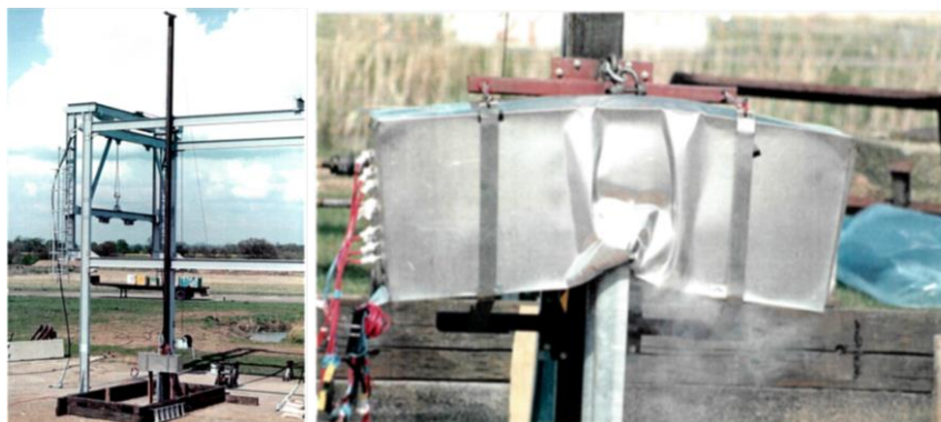
Figura 10. Test di caduta, attrezzatura ed effetti sul modulo [Errore. Il segnalibro non è definito.]
